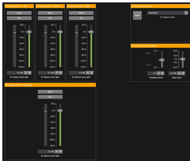
R1内に示されている4つのEn-Space入力: 上部の3つの入力は初期反射面の3つのゾーン（L、C、R）を反映し、4番目は観客エリアを表します。
